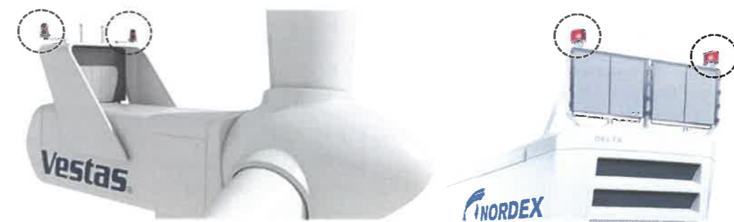
Figure 197 : Exemple de signalisation lumineuse en haut de nacelle (Source : NORDEX, VESTAS)
